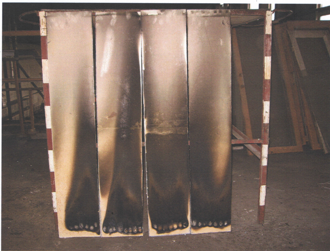
Внешний вид стеклопластиковых изделий изготовленных методом ручной формовки по ТУ 2296-001-79777832-2009 после испытаний по ГОСТ 30244 метод II
